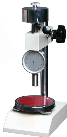
Стойка для твердомеров Шора ТША-1 и ТШЦ-1 Цена: 150 Евро
