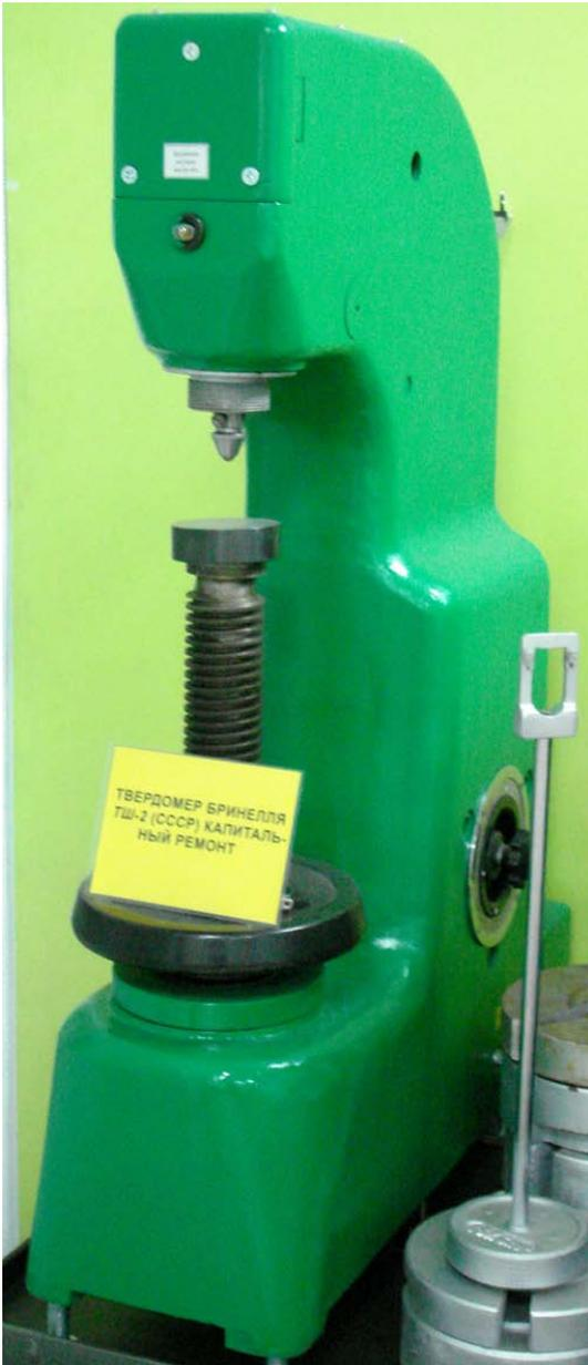
Твердомер предназначен для измерения твердости металлов и сплавов по методу Бринелля.
