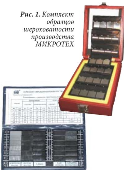
Рис.2. Сверхкомпактные образцы-детали шероховатости МИКРОТЕХ® (по украинскому стандарту ДСТУ)
